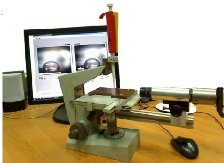
Рисунок 6 – Установки для измерения краевого угла смачивания «Капля-2»
